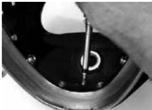
先卸下头盔壳体內的3个螺钉，再卸下排水阀阀体
