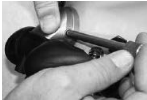
排水阀转接器盖必须完全扣住头盔排水阀
