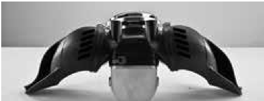
排气罩必须位置准确地安装在四通排气阀阀体上
